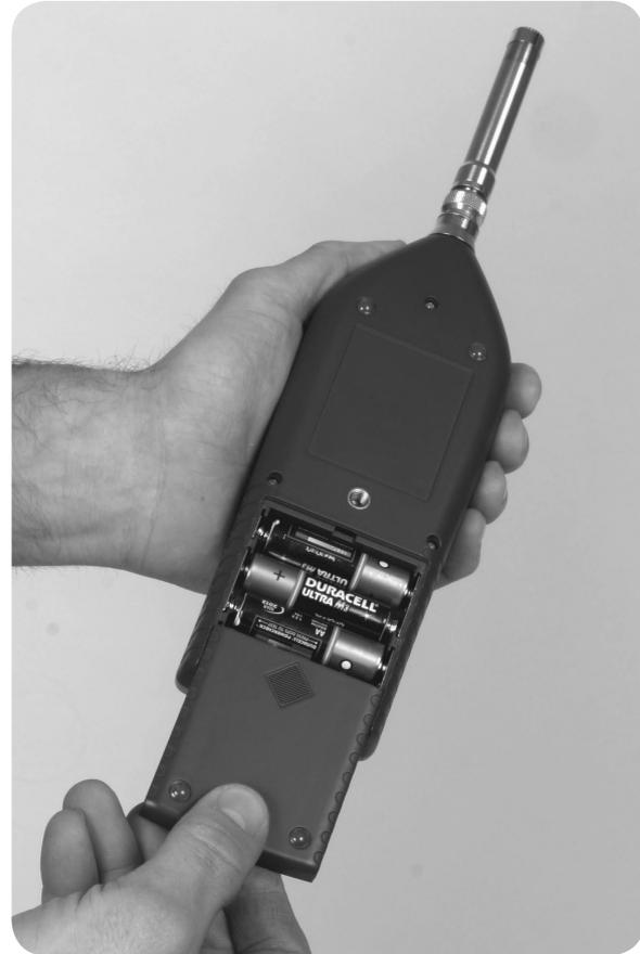
Wird das Messgerät längere Zeit gelagert, empfehlen wir das Entfernen der Batterien um ein mögliches Auslaufen der Batterien zu vermeiden. Nehmen Sie dann das Gerät wieder in Betrieb, müssen Sie allerdings Datum und Uhrzeit neu einstellen. Beachten Sie, dass das Datum im automatischen Filenamen verwendet wird, wenn Messdaten gespeichert werden. Ist das Datum falsch eingestellt, könnten alte und neue Messdaten vermischelt werden.
