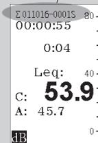
Die oberste Zeile im Display zeigt an, welches File geladen wurde. R steht für „geladen“ („recalled“)
