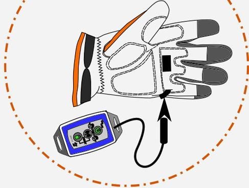
Der Sensor und die Analyseeinheit sind auf einem speziell entworfenen Handschuh montiert. Der Sensor ist in einer angefertigten Tasche in der Handfläche montiert. Gemäß Standard ISO-5349.
